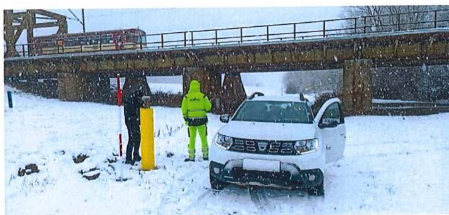
Obr. 3 obr. 2 , úsek Kúty (mimo) – štátna hranica, GNSS meranie – statická metóda
